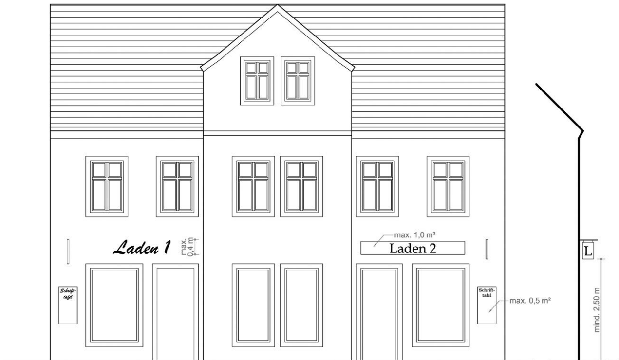
Prinzipiskizze zur Anbringung von Werbeanlagen am Gebäude (Schriftzug, Ausleger, Schrifttafel)
