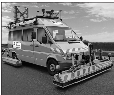
Messfahrzeug mit schnellfahrenden Messsystem ARGUS
